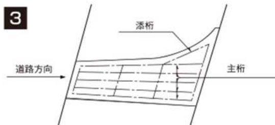
図-1 プレベーム桁の平面配置
